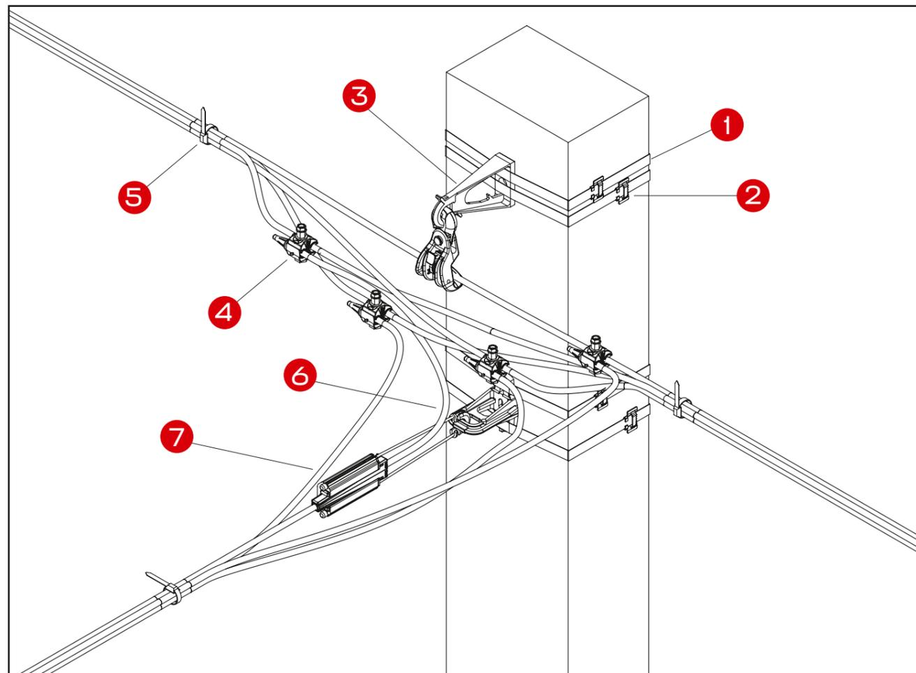
Перечень арматуры, необходимой для монтажа узла на основе проводов СИП 2×50+54,6+25 и СИП 2×35+54,6
