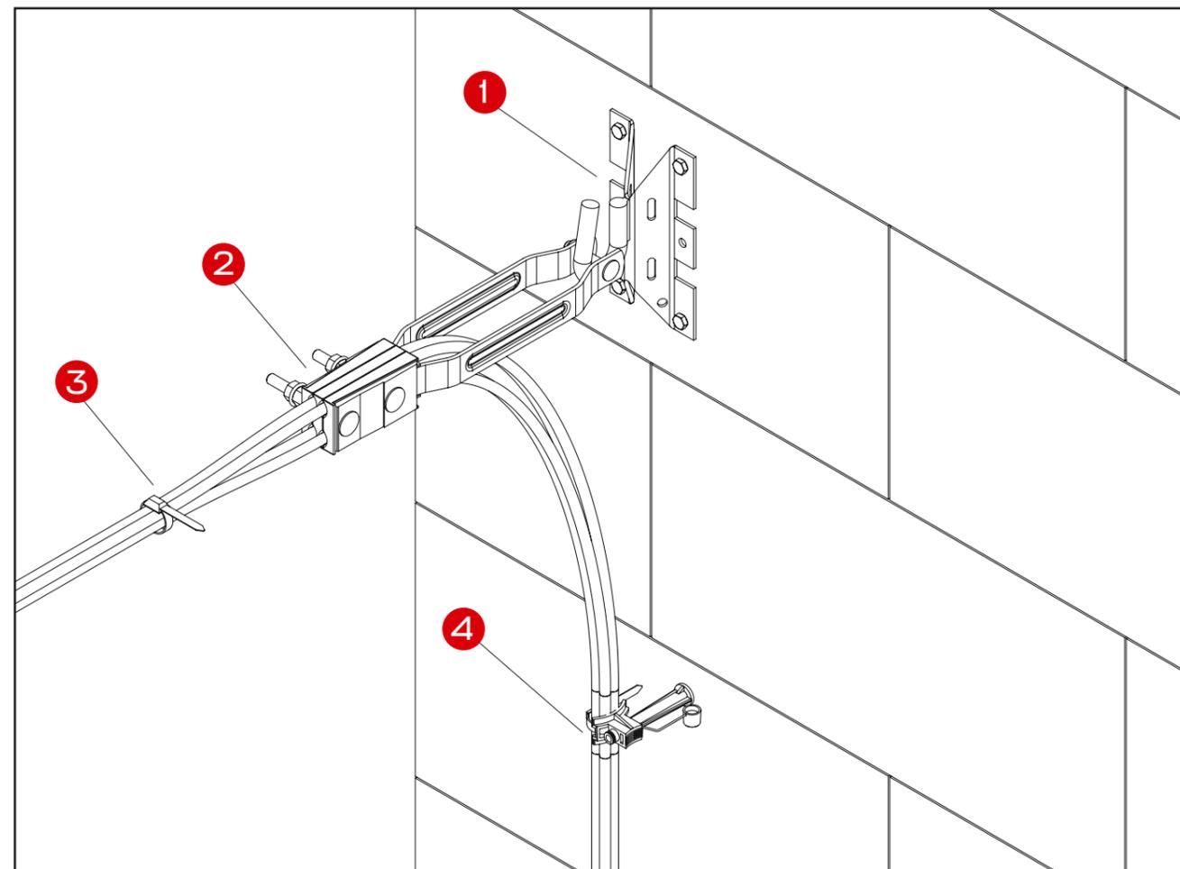
Перечень арматуры, необходимой для монтажа узла на основе провода СИП 4×35
