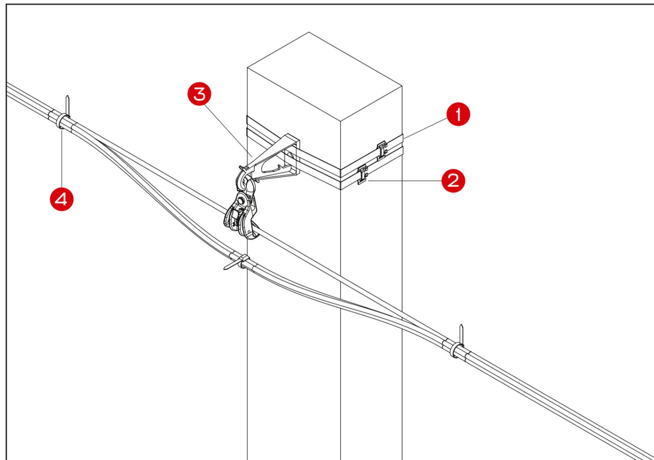
Перечень арматуры, необходимой для монтажа узла на основе провода СИП 2×50+54,6+25
