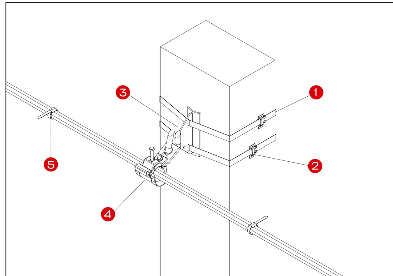
Перечень арматуры, необходимой для монтажа узла на основе провода СИП 4×50+25
