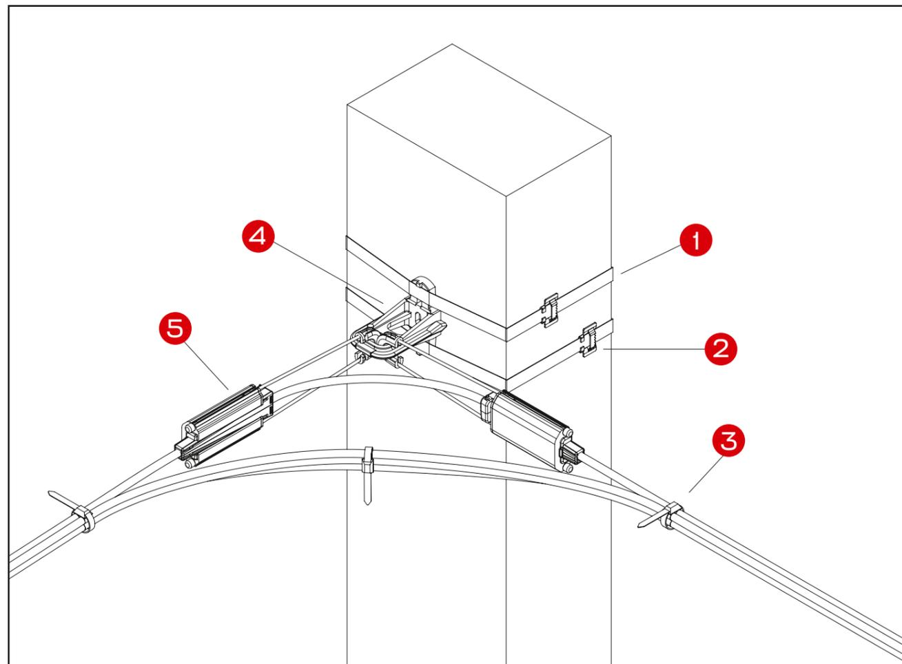
Перечень арматуры, необходимой для монтажа узла на основе проводов СИП 2×50+54,6+25 и СИП 3×35+54,6
