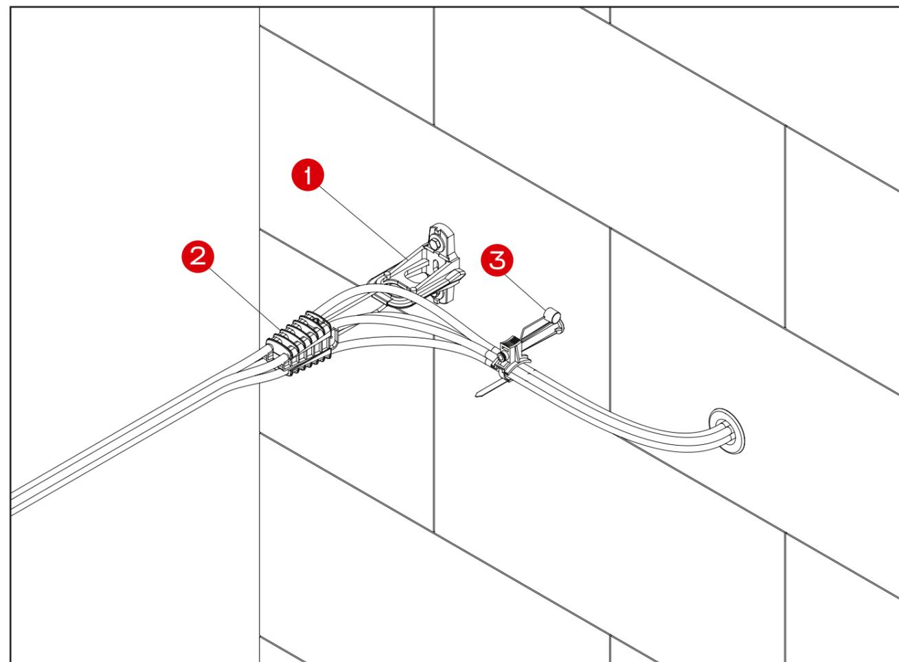
Перечень арматуры, необходимой для монтажа узла на основе провода СИП 4×16
