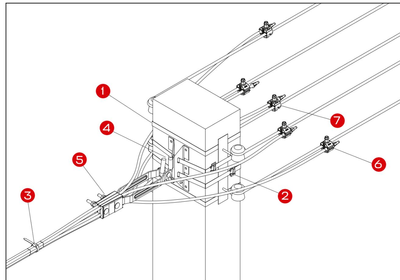
Перечень арматуры, необходимой для монтажа узла на основе провода СИП 2×50+54,6+25 и неизолированной воздушной линии 4×70+25
