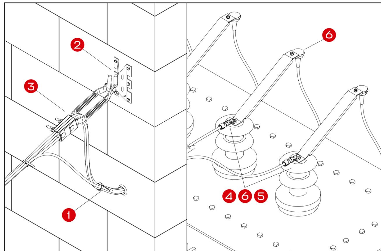
Перечень арматуры, необходимой для монтажа узла на основе провода СИП 4×50+25
