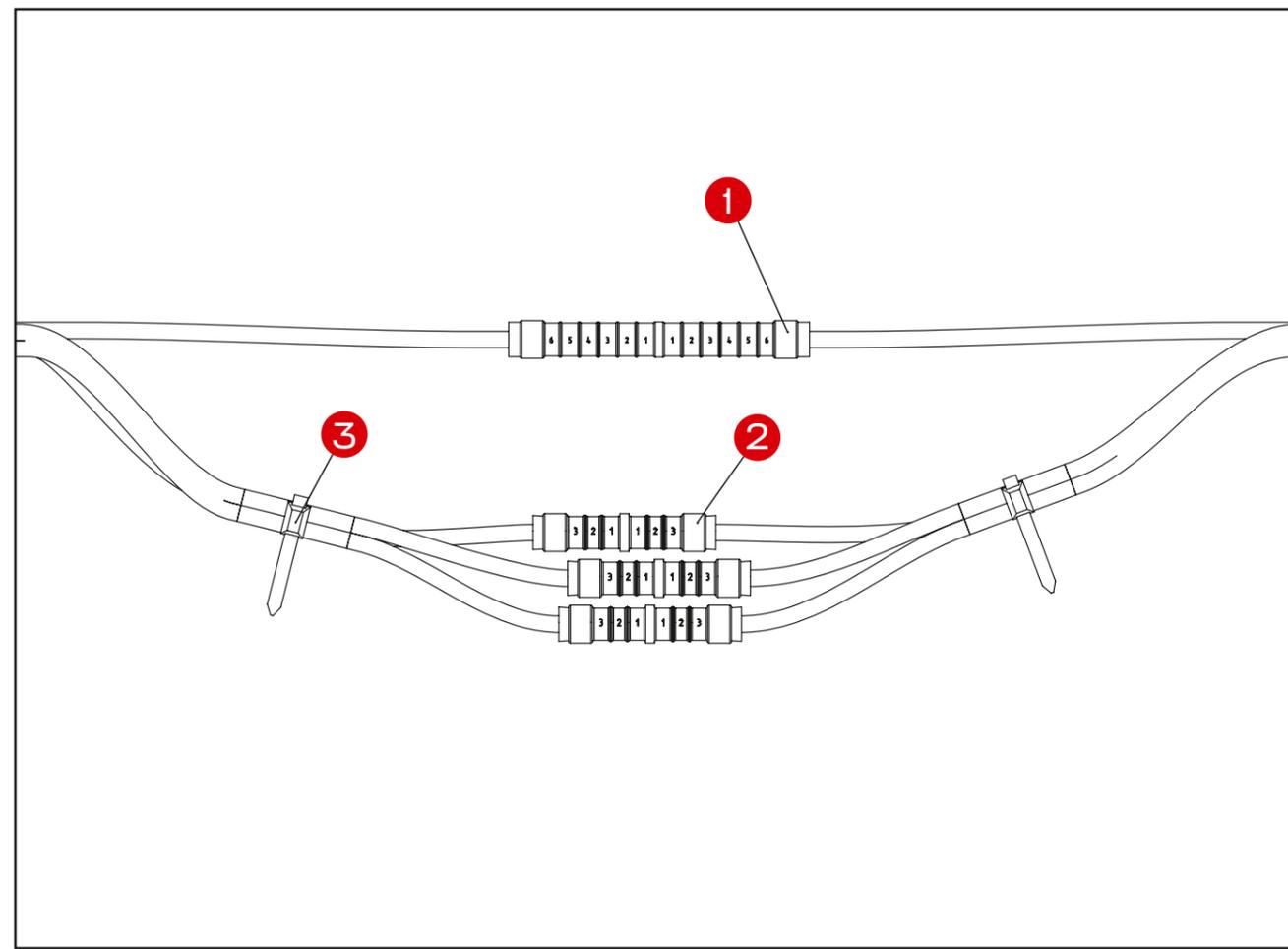
Перечень арматуры, необходимой для монтажа узла на основе провода СИП 2×50+54,6+25
