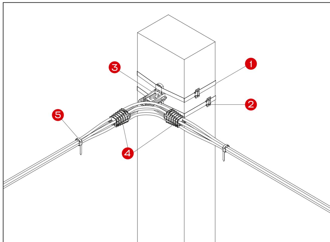
Перечень арматуры, необходимой для монтажа узла на основе провода СИП 4×35+54,6
