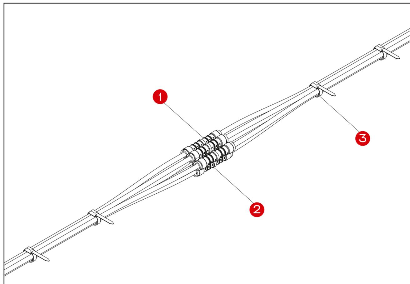
Перечень арматуры, необходимой для монтажа узла на основе провода СИП 4×50+54,6+25
