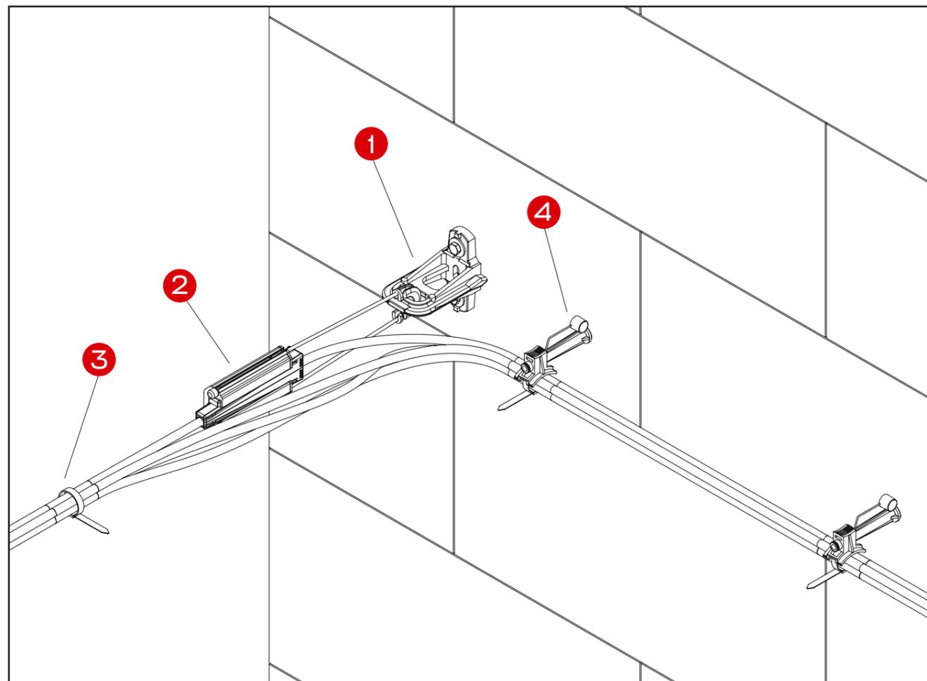
Перечень арматуры, необходимой для монтажа узла на основе провода СИП 2×35+5,6
