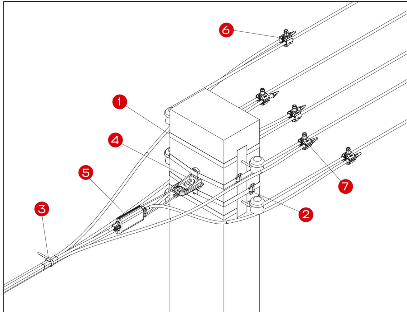
Перечень арматуры, необходимой для монтажа узла на основе провода СИП 4×50+25 и неизолированной воздушной линии 4×70+25
