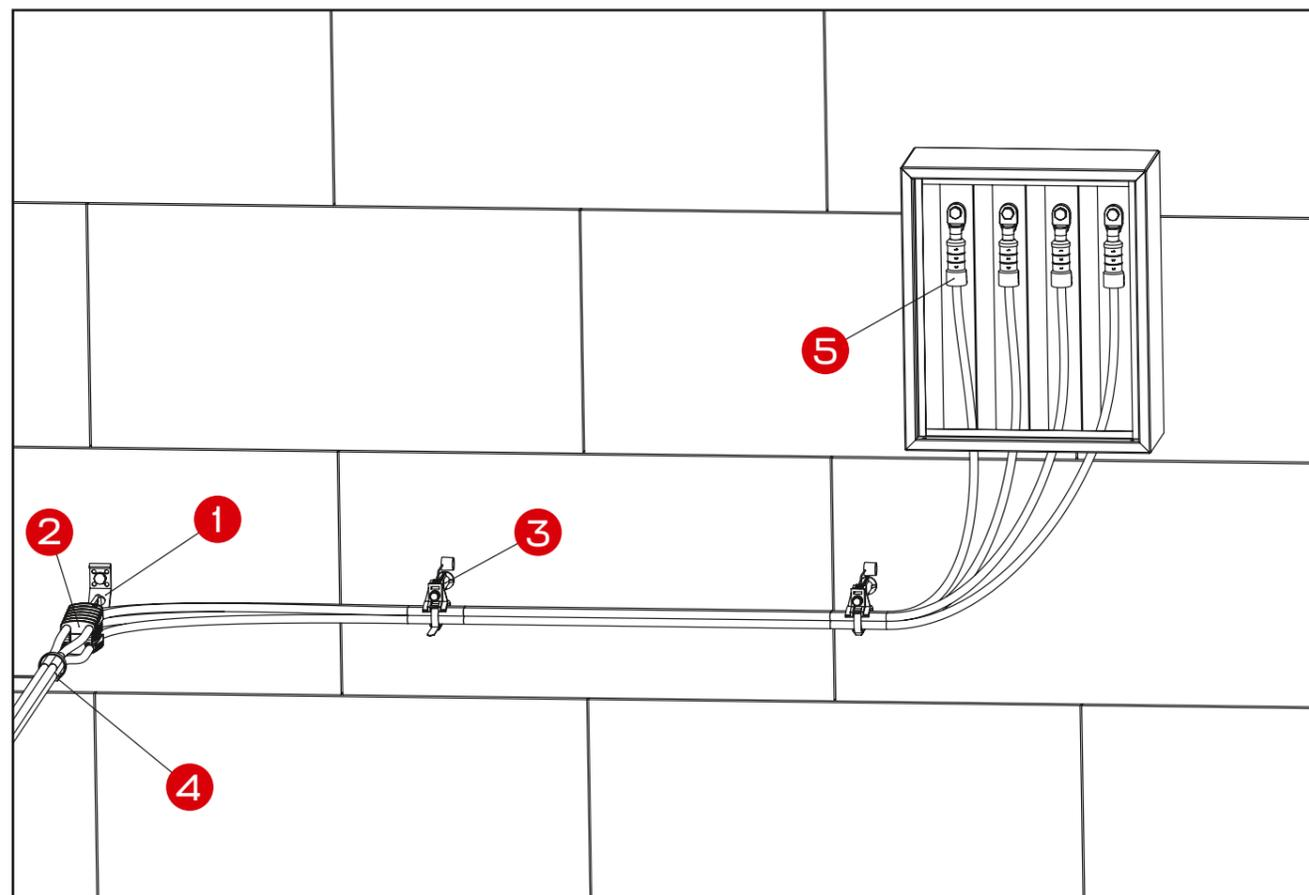
Перечень арматуры, необходимой для монтажа узла на основе проводов СИП 2×50+25 и СИП 3×50+25
