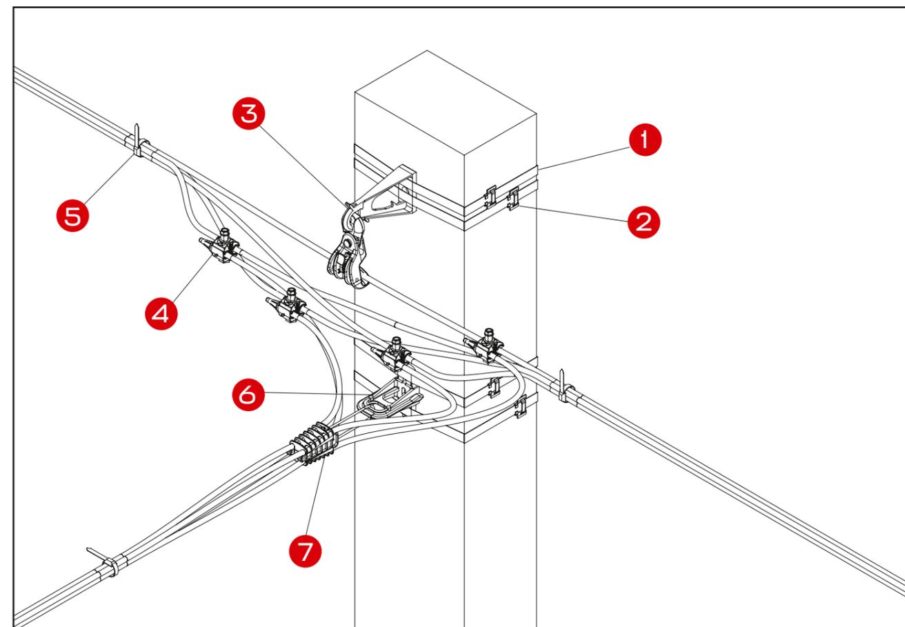
Перечень арматуры, необходимой для монтажа узла на основе проводов СИП 2×50+25 и СИП 4×35
