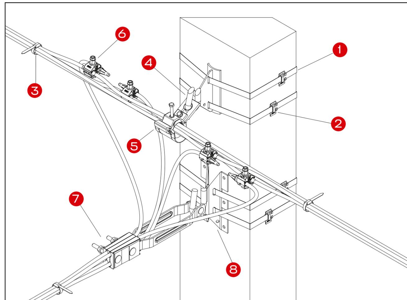
Перечень арматуры, необходимой для монтажа узла на основе проводов СИП 4×50+25 и СИП 4×35
